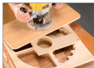
Termine el trabajo utilizando la fresa para bandejas insertada en el mandril.
