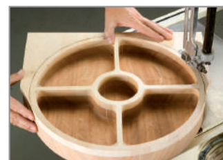
Trabaje la parte exterior de la bandeja utilizando una sierra de cinta.
