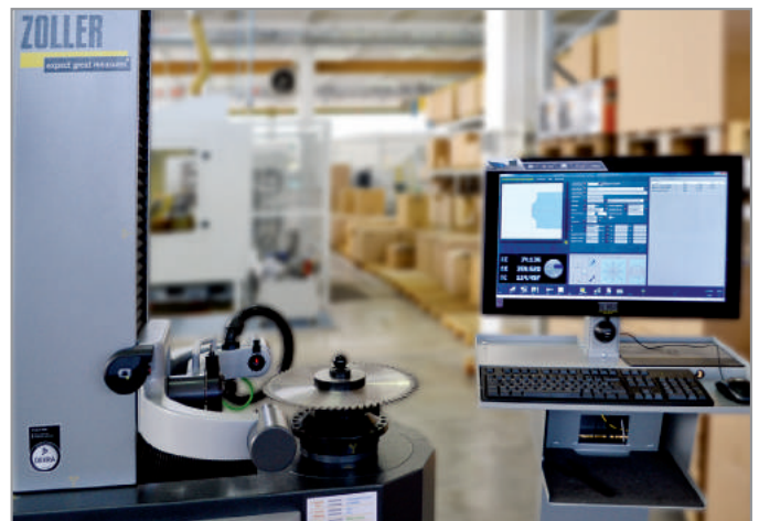
El sistema de medida CMT es completamente automático.
