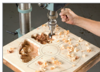
Quite el material utilizando una broca Forstner de 50,8mm en una taladradora de columna.
